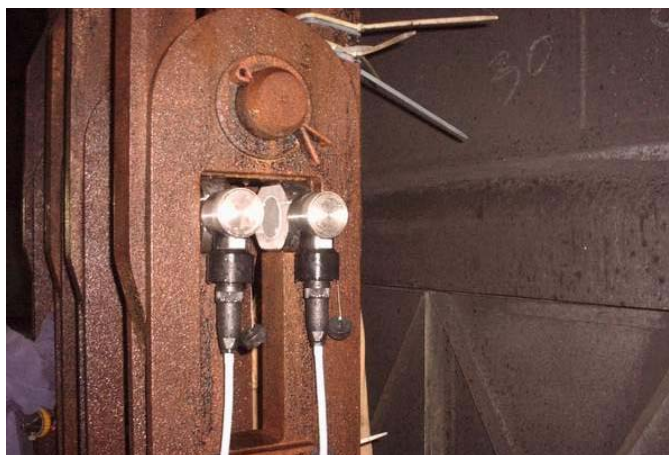
Foto 7. Wkładki WPS-Ec zabudowane w łączniku do zmiany długości lin (LW „Bogdanka”)
