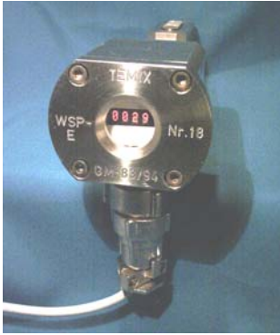
Foto 3. Wkładka pomiarowa siły WPS-E
